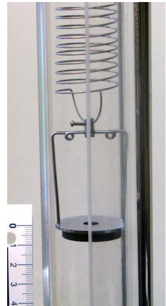
Uchwyt z magnesami poruszający się wewnątrz rury
